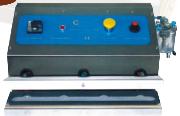
Confezionatrice sottovuoto semi-automatica asp. est. + sep. liquidi 2 barre saldanti 430 mm, pompa da 3m 3 /h, peso: 26 kg, dim.: 450 x 400 x 250 mm
